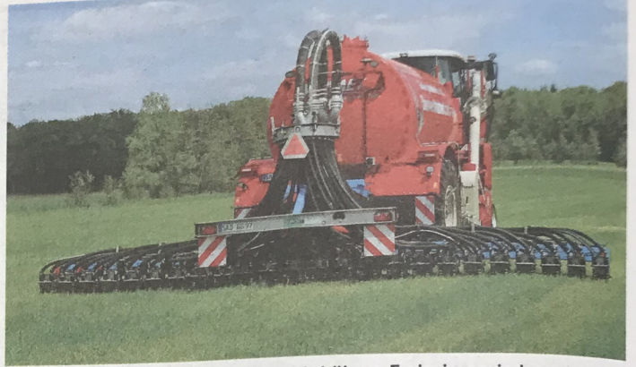
Mit dem Schlitzgerät können noch höhere Emissionsminderungen erzielt werden. Je nachdem, wie tief die Ablage erfolgt, sind Minderungen um bis zu 90 % möglich.
