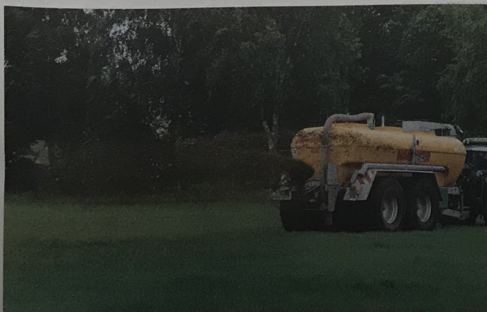
Um die Emissionen von Ammoniak massiv zu vermindern, sind Breitverteiler – wie hier der Schwenkverteiler – ab dem Jahr 2025 auf Grünlandflächen nicht mehr zulässig.
