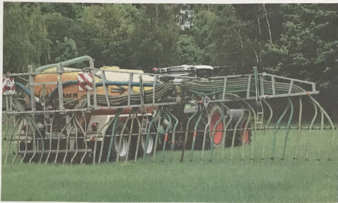
Dicke Güllen mit dem Schleppschlauch ausgebracht, führen zu dicken Güllebändern, die vor allem bei trockenen und warmen Bedingungen zum Aufwachsen der „Güllewürste“ führen.
